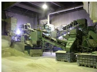
ALC (Autoclaved Lightweight Concrete = 軽量気泡コンクリート) 廃材の専用リサイクル施設。メーカー及び建設現場からこれを受入れ、破碎処理工程中に粒度を整え、人工軽量土壌及びセメント原料にてリサイクル。人工軽量土壌の場合、ALCを破碎すると角ができ、植木又は草花の根を切ってしまう。弊社独自の破碎工程で、角の無い丸みの粒が精製され、人工軽量土壌及び改良土としてリサイクルしている。
