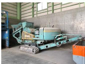
異物付の ALC 廃材を選別破碎する施設。建設現場から受入れた処理困難な ALC が処理できることでより多くのリサイクル処理が可能となる。選別した異物については弊社伊奈平工場で適切に処理する。
