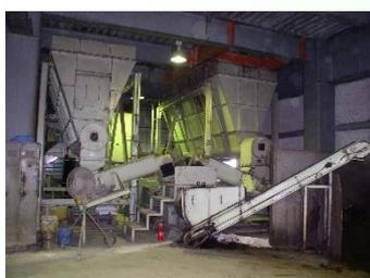
動植物性残さ（生ごみ）、汚泥（有機性汚泥に限る。）及び木くず（伐採樹木等）を処理する施設。2種類の廃棄物を高温下で加圧・混練し、発酵を促進させる。発酵後の堆肥は、人工軽量土壌の資材としてリサイクルしている。
