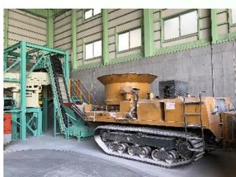
伐採樹木や廃材等の木くずを処理する施設。堆肥や人工軽量土壌の原料となる伐採樹木については、当破碎施設で粗破碎することで、加圧混練機や発酵施設に投入する適切なサイズに処理する。
